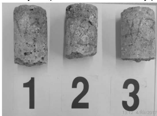
FOTO č.1: Dokumentace vývrtů pro destruktivní zkoušky pevnosti betonu
