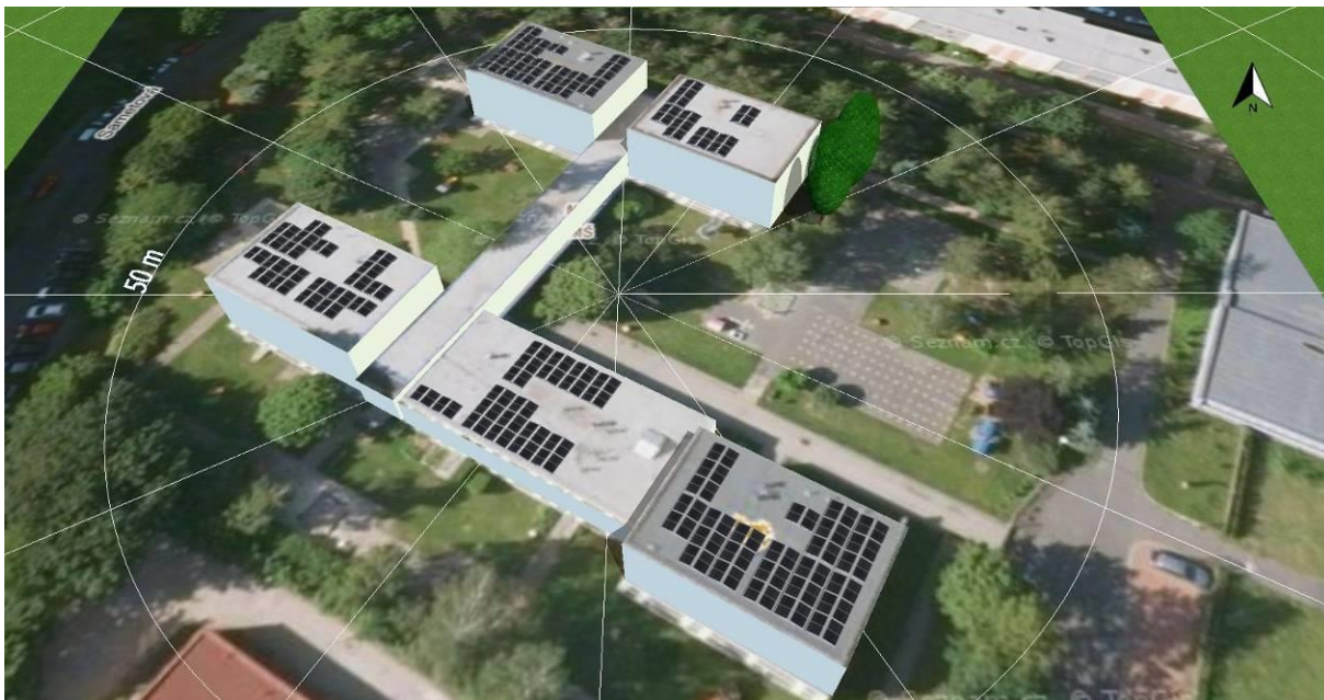
Obr. 27: 3D model FV elektrárny – MŠ Motýlek
