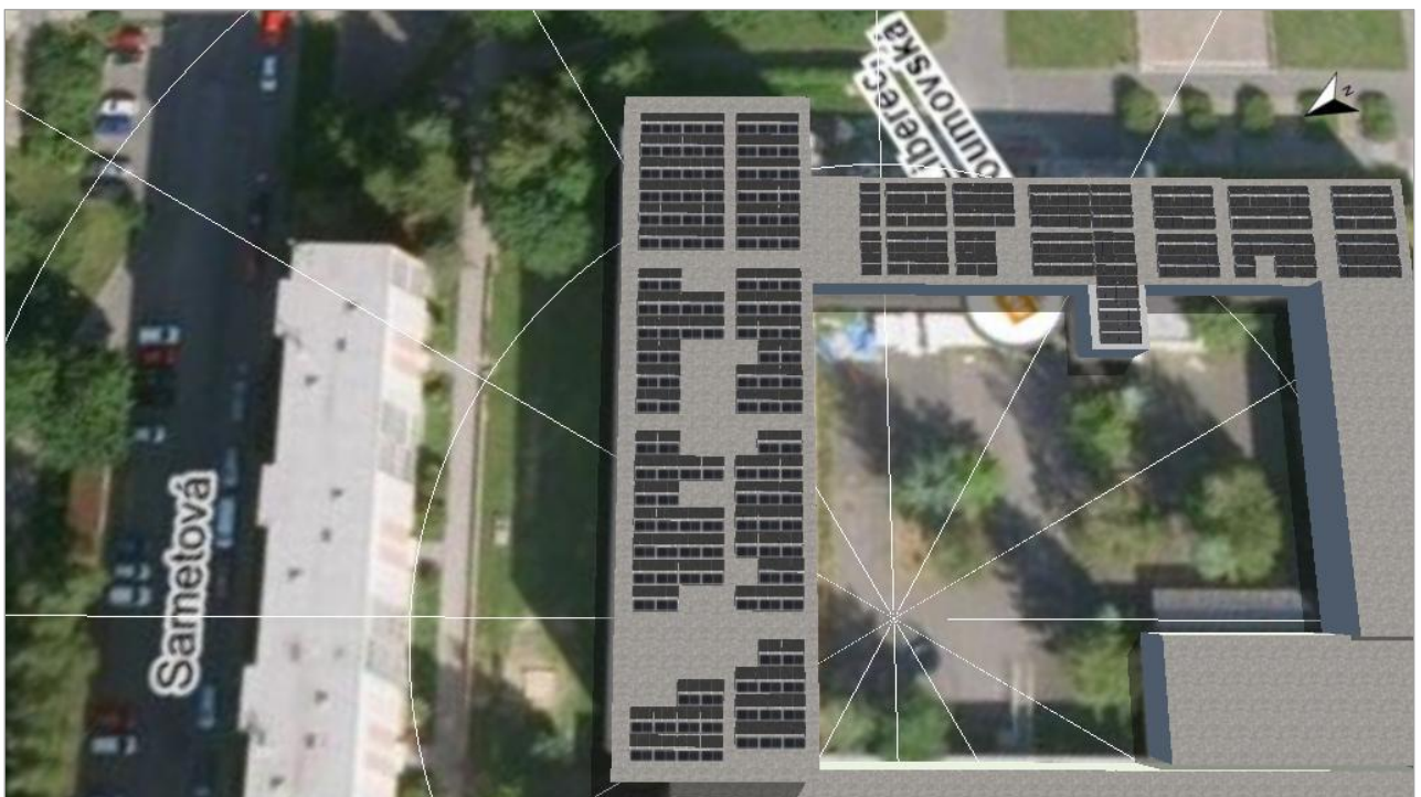
Obrázek: 1. Umístění modulu - Střecha 2 + 3-Oblast modulu Severozápad
