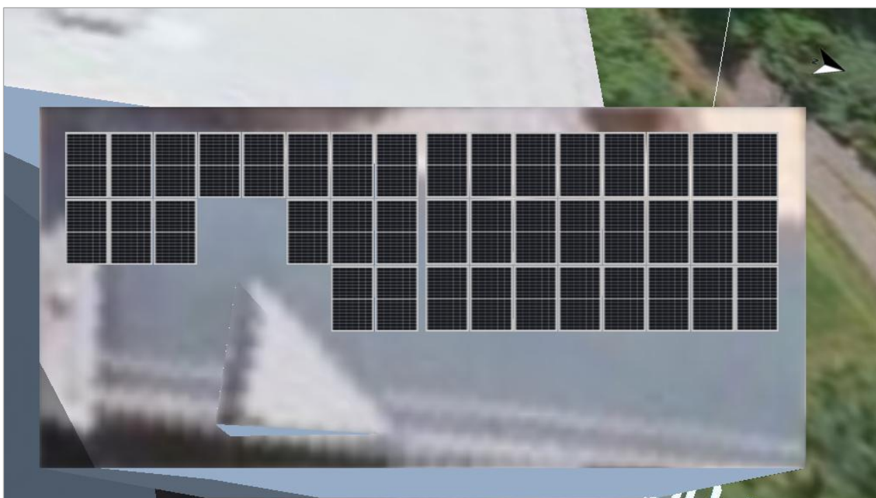
Obrázek: 2. Umístění modulu - Budova C - východ-Plocha střechy Východ
