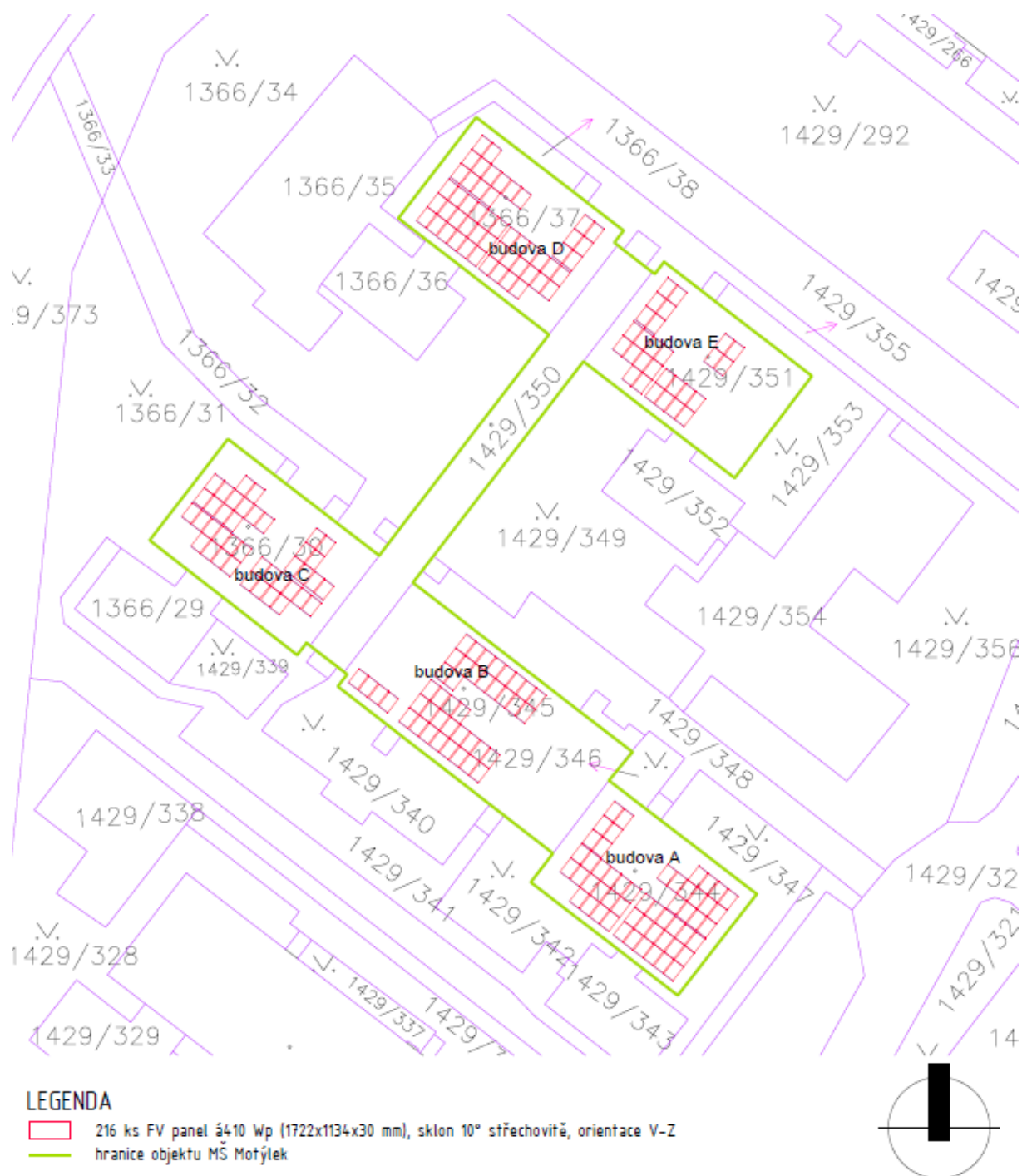
Obr. 26: Situační mapa s vyznačenou oblastí pro instalaci FV panelů – MŠ Motýlek. Zdroj: Projektová studie.
