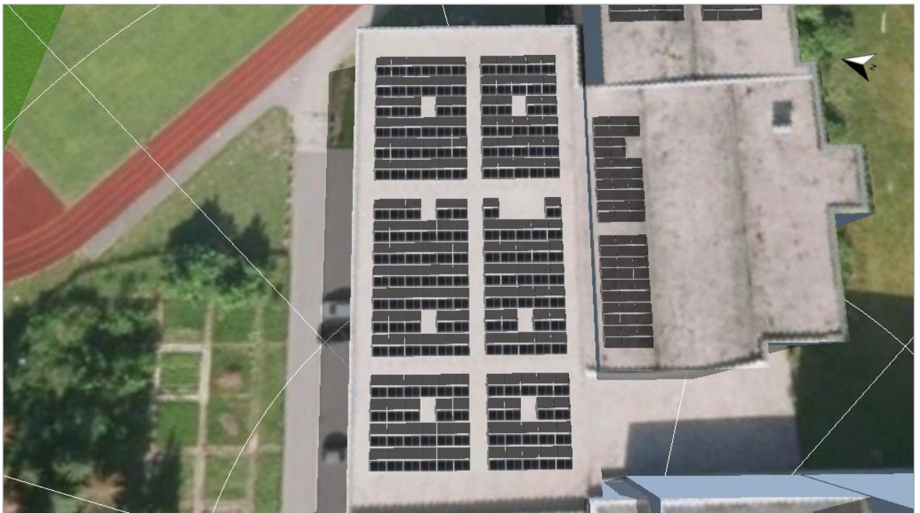
Obrázek: 3. Umístění modulu - Střecha 1-Oblast modulu Západ
