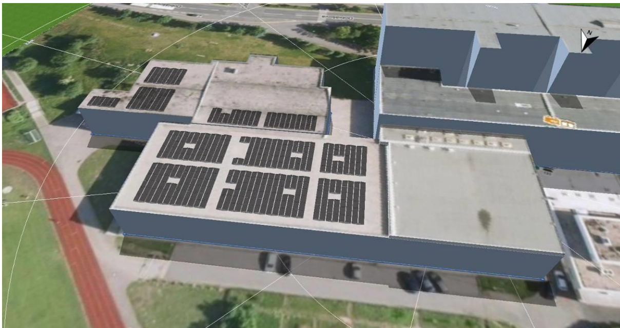
Obr. 15: 3D model FV elektrárny – ZŠ Dobiášova
