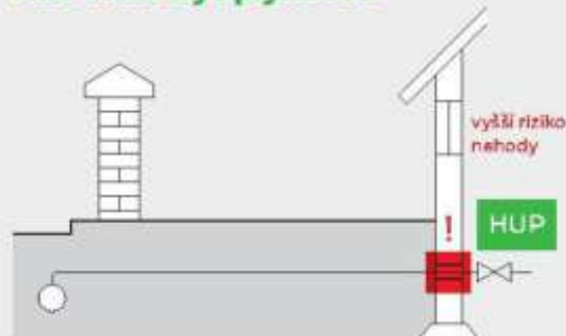
Plynovodní přípojka vstupuje do domu skrz základy. Hlavní uzávěr plynu (HUP) je uvnitř (např. ve sklepě).
