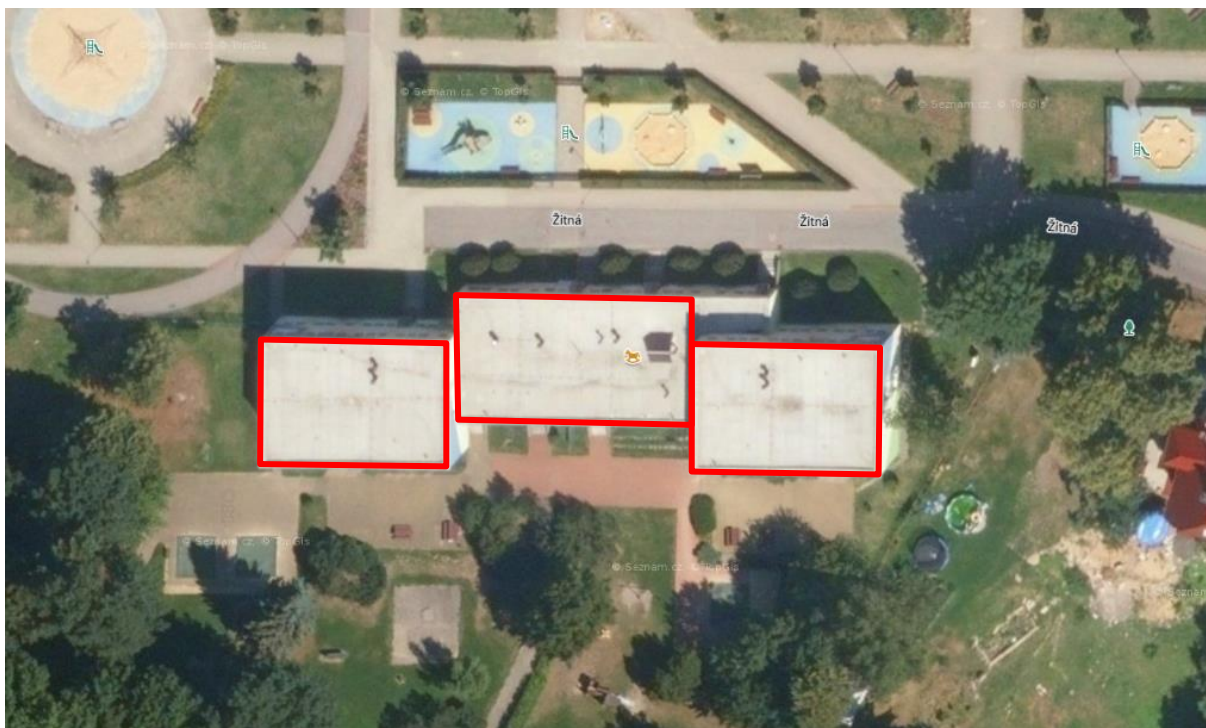
Obr. 30: Vyznačení plochy k instalaci FVE na střeše objektu – MŠ Klíček. Zdroj: https://mapy.cz .
