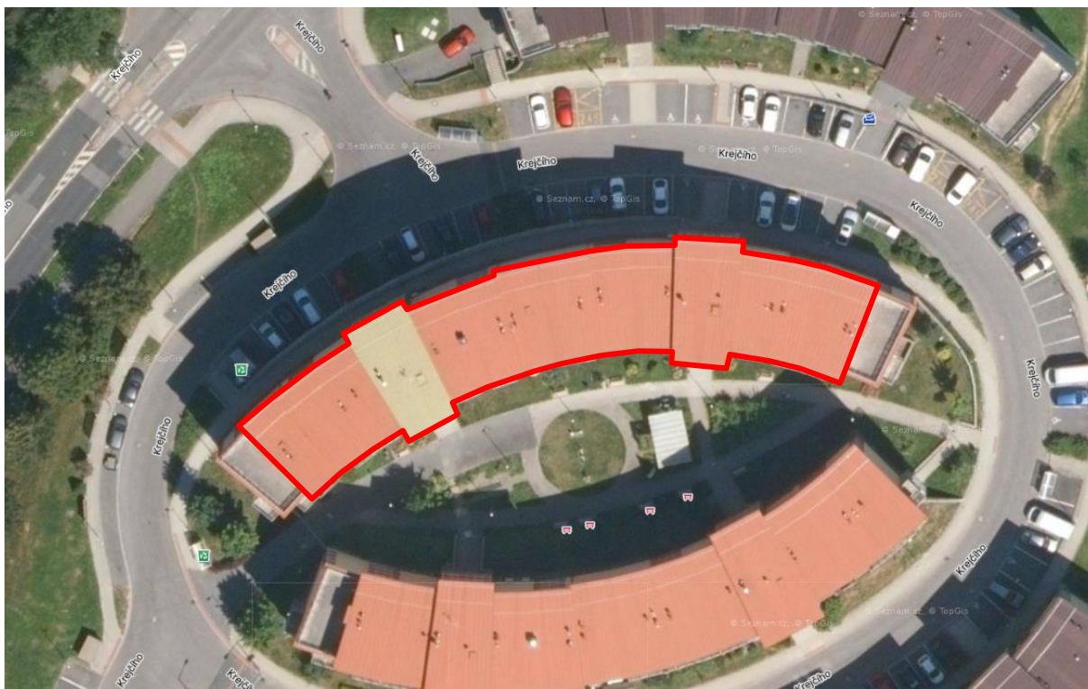
Obr. 20: Vyznačení plochy k instalaci FVE na střeše objektu - BD Krejčího 1173/5. Zdroj: https://mapy.cz .
