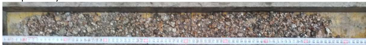
Foto 3: Štěrkovitý materiál z rozvrtaného granitu , vrt V3.
