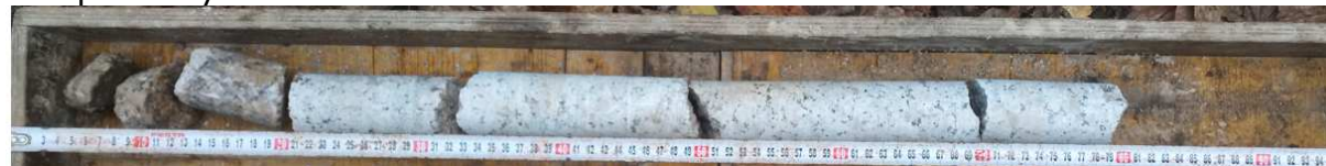
Foto 2: Zdravý až navětralý granit, při povrchu navětralý, vrt V2.
