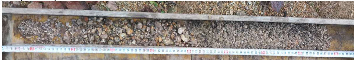
Foto 1: Štěrkovitý materiál z rozvrtaného granitu , vrt V1.
